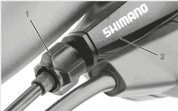
Figura 68: Casquillo de ajuste (1) del cambio de marchas accionado por cable de accionamiento con carcasa de la palanca de cambio (2), ejemplo
