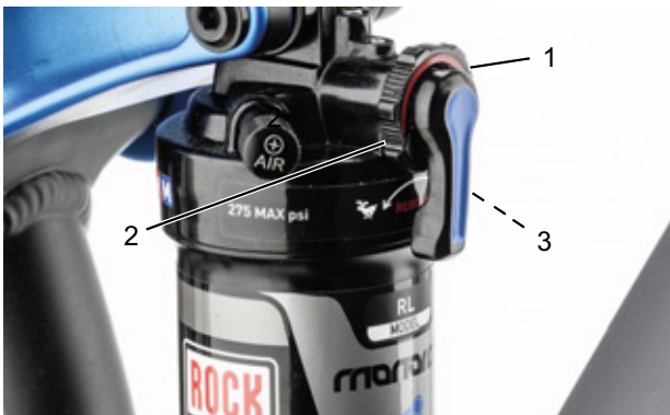
Figura 61: Ajuste de la dureza del amortiguador de niveles de tracción en la rueda de ajuste (1) del amortiguador de la horquilla trasera
