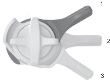
Figura 59: Regulador de niveles de presión FOX en el amortiguador de la horquilla trasera con las posiciones ABIERTO (1), MEDIO (2) y DURO (3)
