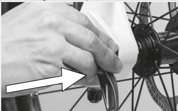
Figura 26: Inserción del cierre rápido
