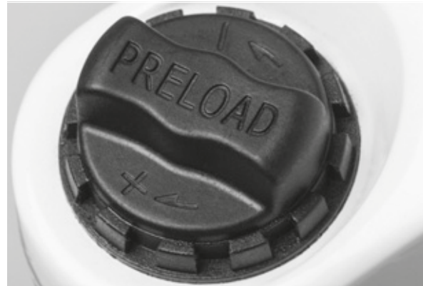
Figura 45: Rueda de ajuste del recorrido de muelle negativo en la corona de la horquilla de suspensión
