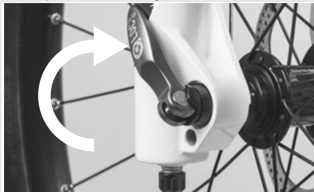
Figura 28: Cierre del cierre rápido
