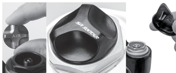
Abbildung 46: Schraubabdeckungen in unterschiedlichen Ausführungen
