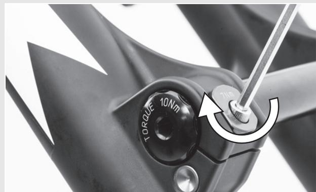
Abbildung 18: Sicherheitsklemme anziehen
