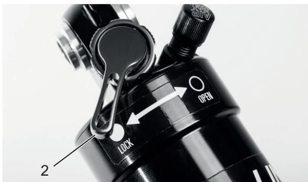
Abbildung 57: Suntour-Druckstufen-Einsteller geschlossen (2)
