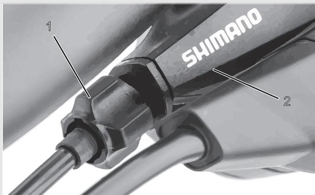
Abbildung 68: Einstellhülse (1) der einzügigen, seilzugbetätigten Gangschaltung mit Schalthebelgehäuse (2), Beispiel
