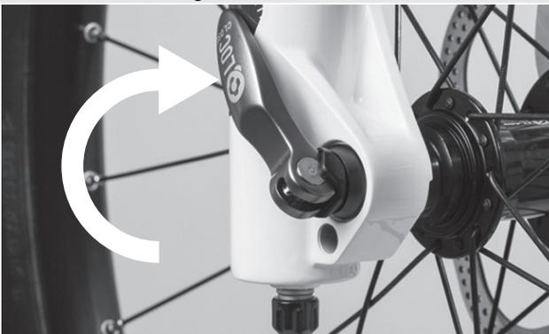
Abbildung 28: Schnellspanner schließen
