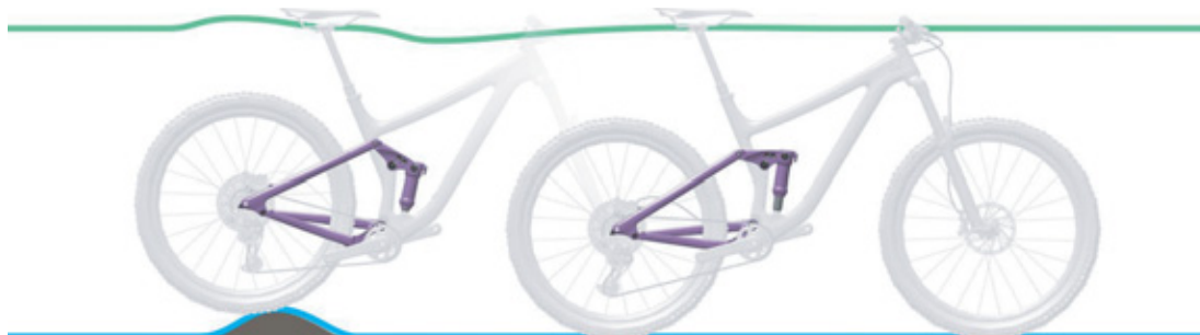
12. ábra: A hátsó lengéscsillapító optimális menetviselkedése egyenetlenségeknél
