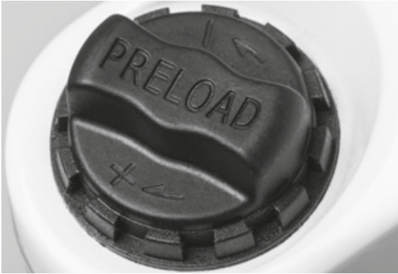
45. ábra: Az SAG (negatív rugóút) beállító kereke a teleszkópos villa koronáján
