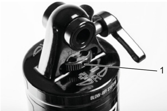
81. ábra: Húzófokozatos lengéscsillapító fordítása az óramutató járásával egyező irányban
