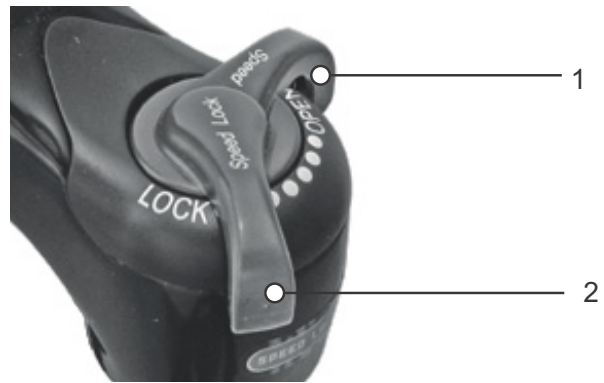
64. ábra: Suntour nyomásfokozat-lengéscsillapító nyitott (1) és zárt (2) helyzetben
