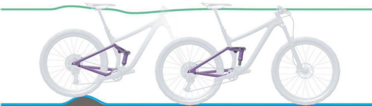
55. ábra: A hátsó lengéscsillapító optimális menetviselkedése egyenetlenségeknél
