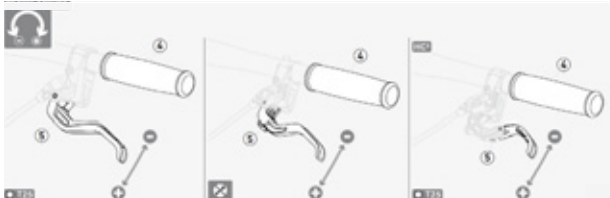
43. ábra: Magura tárcsafék fékkar markolási szélességének beállítása
