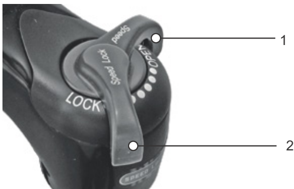
77. ábra: Suntour nyomásfokozat-lengéscsillapító nyitott (1) és zárt (2) helyzetben
