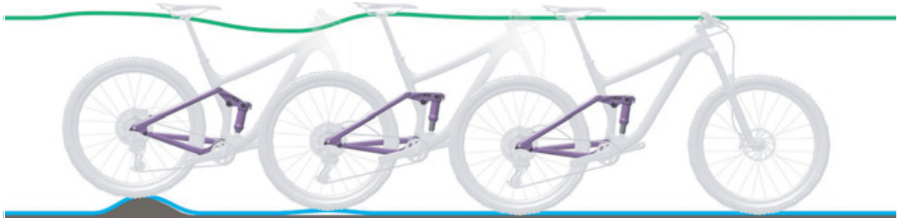
80. ábra: A hátsó lengéscsillapító túl gyors kirugózása
