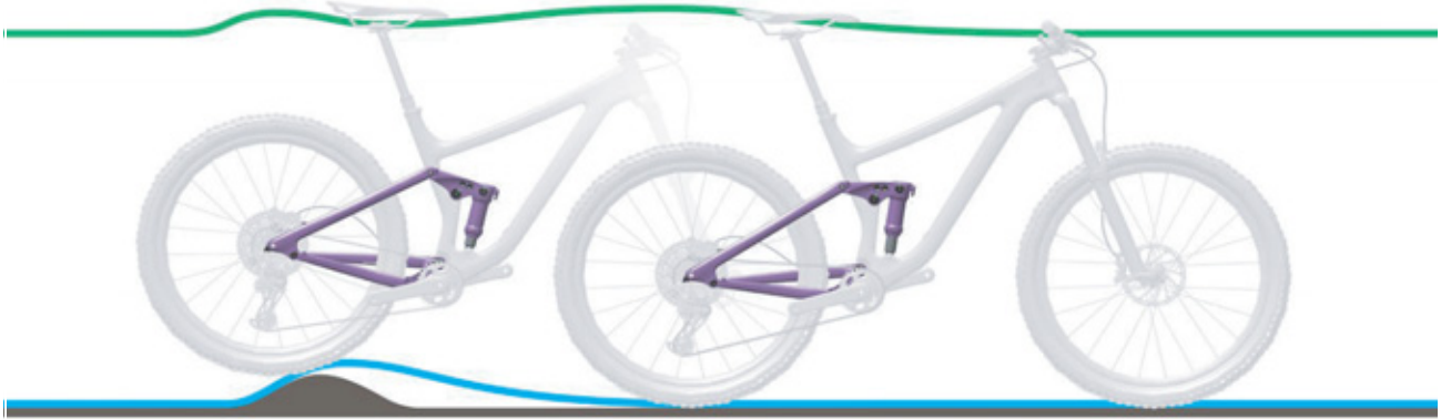
86. ábra: A hátsó lengéscsillapító túl kemény csillapítása egyenetlenségeknél
