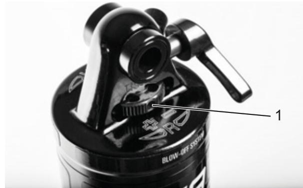
51. ábra: Suntour kerék húzófokozat-beállító (1) a hátsó lengéscsillapítón
