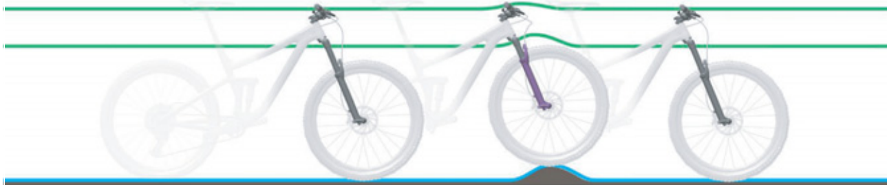
7. ábra: A villa optimális menetviselkedése egyenetlenségek esetén
