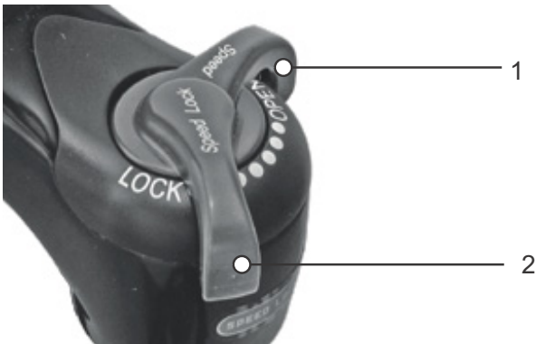
79. ábra: Suntour nyomásfokozat-lengéscsillapító nyitott (1) és zárt (2) helyzetben
