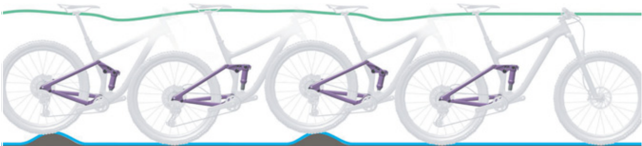
49. ábra: A hátsó lengéscsillapító optimális menetviselkedése
