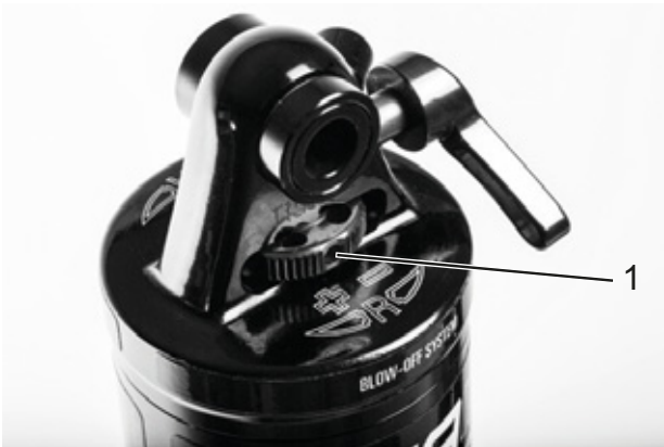
83. ábra: Húzófokozatos lengéscsillapító fordítása az óramutató járásával ellenkező irányban
