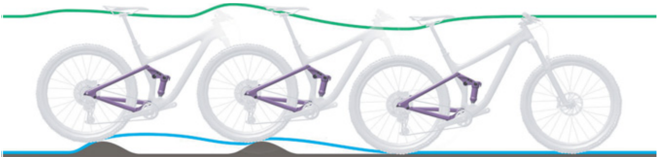
82. ábra: A hátsó lengéscsillapító túl lassú kirugózása
