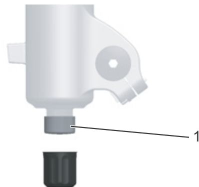
Rysunek 48: Nastawnik odbicia FOX (1) na zabezpieczeniu widełca przed wypadnięciem
