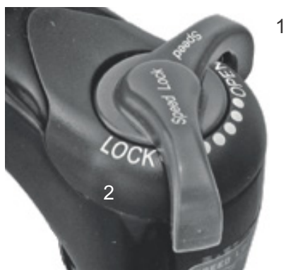
Rysunek 55: Nastawnik dobicia Suntour z pozycjami OPEN (1) i LOCK (2)
