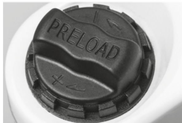
Rysunek 45: Pokrętło regulacyjne ujemnego skoku sprężyny, usytuowane na koronie widelca amortyzowanego
