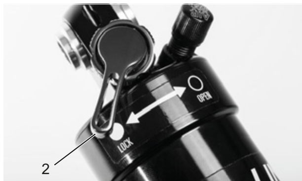
Rysunek 57: Zamknięty nastawnik dobicia Suntour (2)
