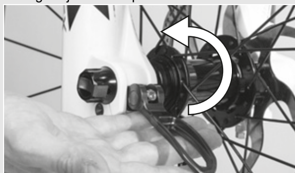
Rysunek 22: Sposób zabezpieczania dźwigni
