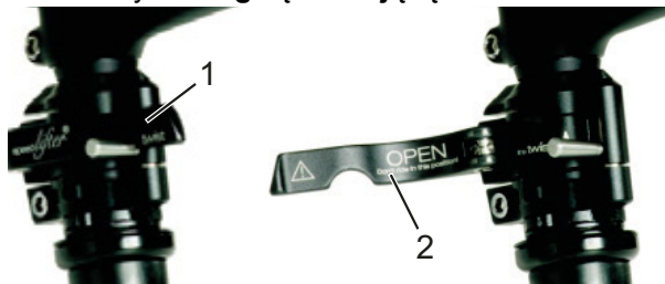
Rysunek 39: Zamknięta (1) i otwarta (2) dźwignia mocująca mostek; przykład – system regulacji wysokości kierownicy speedlifter firmy by.schulz
