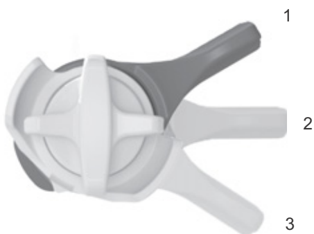
Rysunek 59: Nastawnik dobicia FOX obsługujący tylny amortyzator z pozycjami OTWARTE (1), ŚREDNIE (2) i TWARDE (3)
