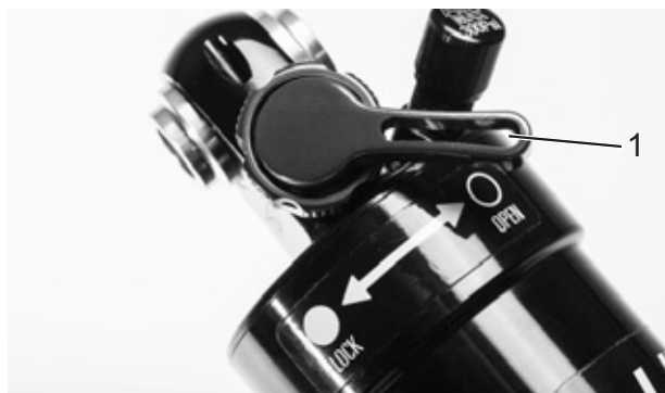
Rysunek 56: Otwarty nastawnik dobicia Suntour (1)
