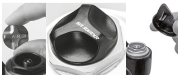
Rysunek 46: Osłony gwintowane w różnych wersjach
