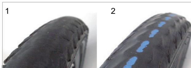
Abbildung 47: Reifen ohne Profil, der gewechselt werden kann (1) und Reifen mit durchscheinendem Pannenschutz (2), der gewechselt werden muss
