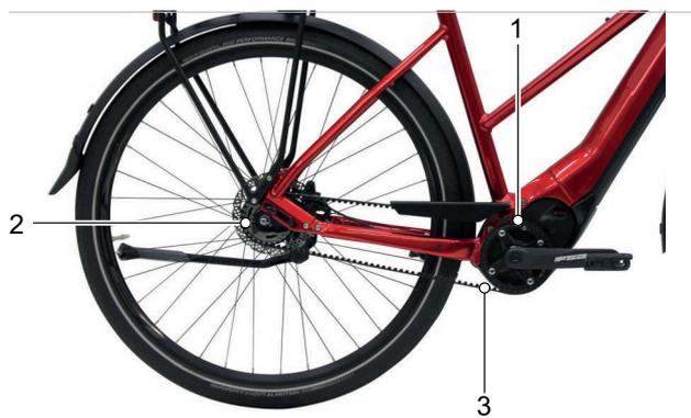
Abbildung 6: Schema Riemenantrieb
