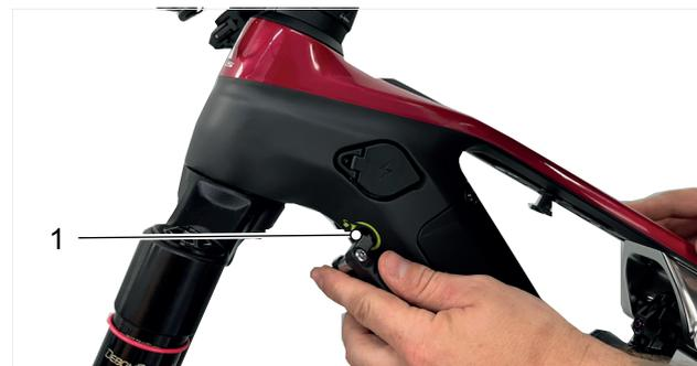
Abbildung 33: Akkus Schloss mit Inbuswerkzeug öffnen
