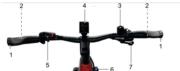
Abbildung 3: Lenker, Beispiel BOSCH LED Remote mit Kiox 300
