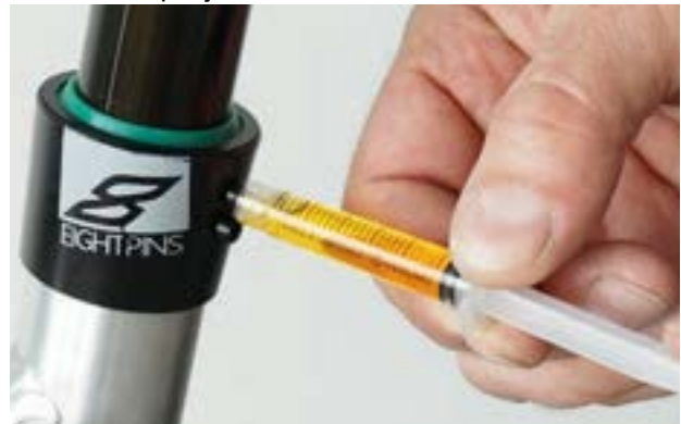
Figur 160: Smøring af eightpins-sadelpind
