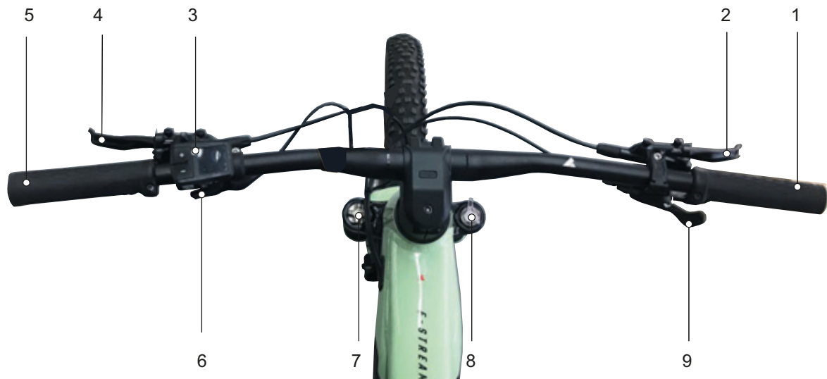
Figur 36: Detaljeret visning af styr med FIT Remote-LCD-cykelcomputer, eksempel
