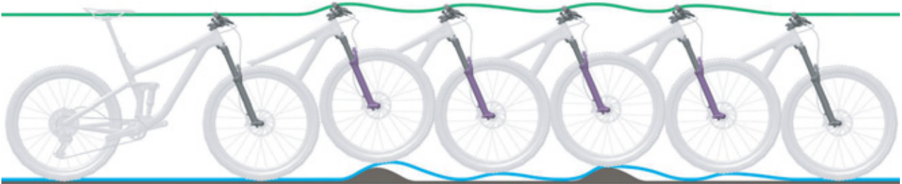
Figur 205: Fjedergaflen fjedrer for hurtigt tilbage
