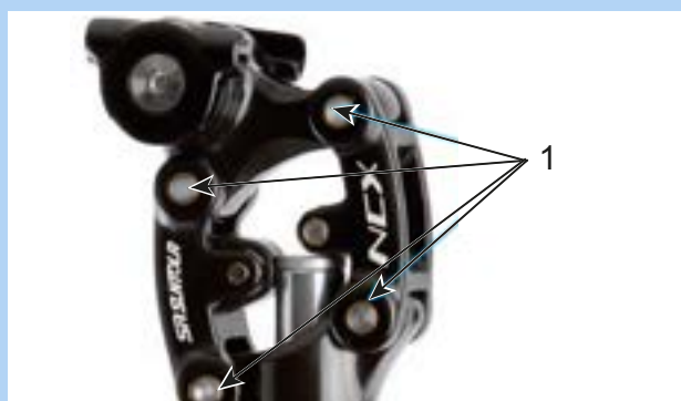
Figur 195: Smørepointter på SR SUNTOUR affjedret sadelpind
