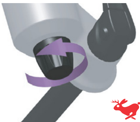
Figur 208: Drej træktrinsskruen hen mod haren
