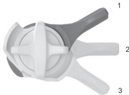
Illustration 59 : Dispositif de réglage de la compression FOX sur l'amortisseur arrière avec les positions OUVERT (1), MOYEN (2) et DUR (3)
