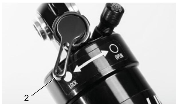
Illustration 57 : Dispositif de réglage de la compression Suntour fermé (2)
