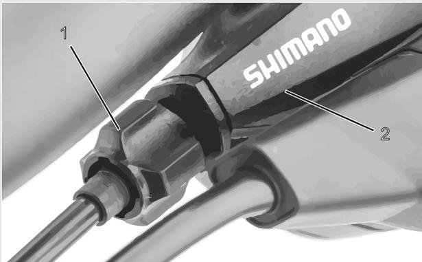
Illustration 68 : Douille de réglage (1) du changement de vitesse à un câble actionné par câble avec boîtier de manette de vitesse (2), exemple
