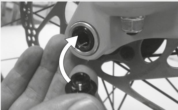
Illustration 15 : Enfoncer le levier d'attache rapide dans l'axe
