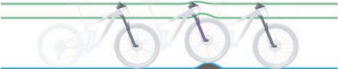
Abbildung 11: Optimales Fahrverhalten der Gabel bei Unebenheiten
