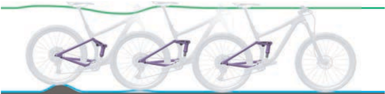
Abbildung 244: Zu schnelles Ausfedern des Hinterbau-Dämpfers
