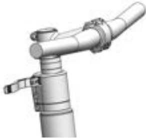
Abbildung 155: All Up mit geöffnetem Vorbau-Spannhebel
