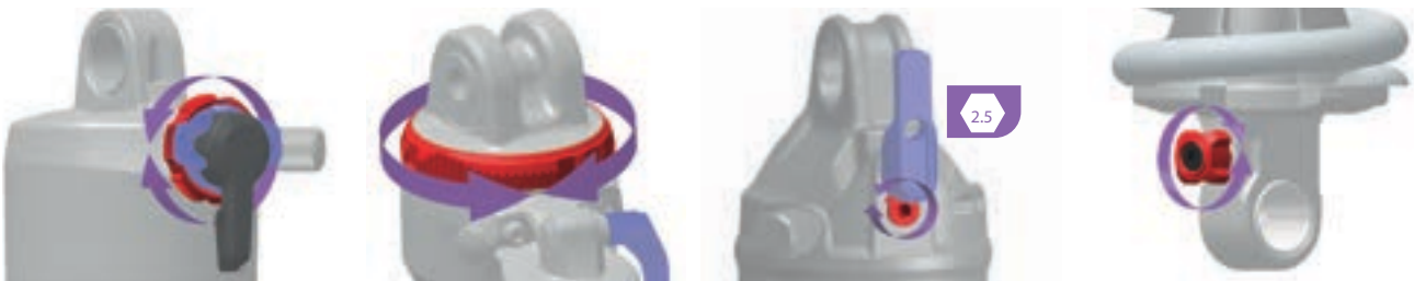
Abbildung 112: Lage und Form des Zugstufeneinstellers (rot) ist abhängig vom Modell
