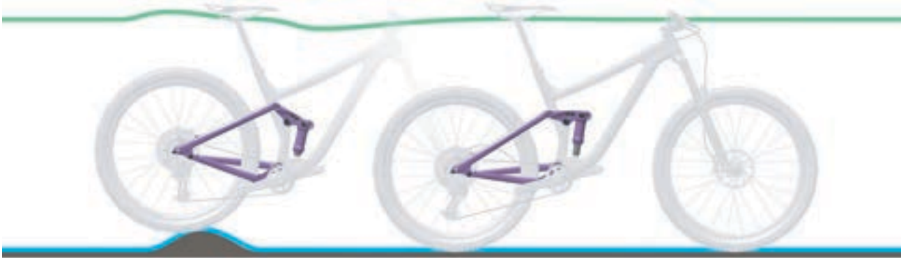
Abbildung 113: Optimales Fahrverhalten des Hinterbau-Dämpfers bei Unebenheiten
