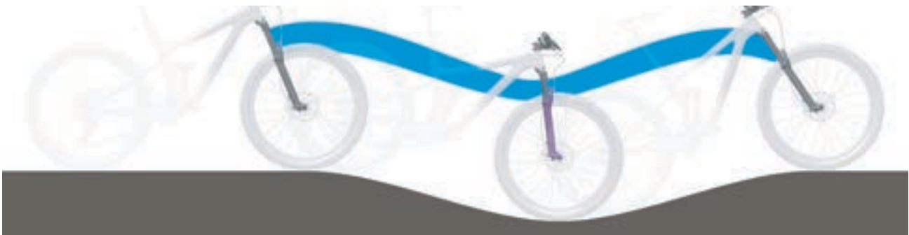
Abbildung 10: Optimales Fahrverhalten der Gabel im hügeligen Gelände
