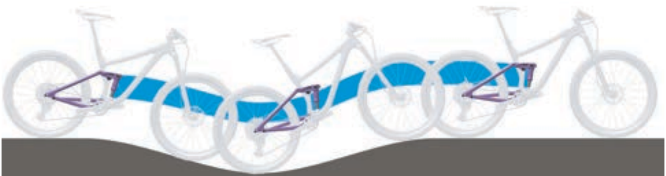
Abbildung 17: Optimales Fahrverhalten des Hinterbau-Dämpfers im hügeligen Gelände
