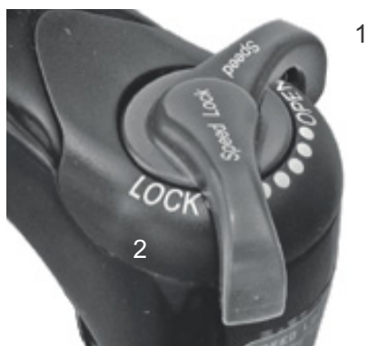
Figura 55: Regolatore dello stadio di pressione Suntour con posizioni OPEN (1) e LOCK (2)
