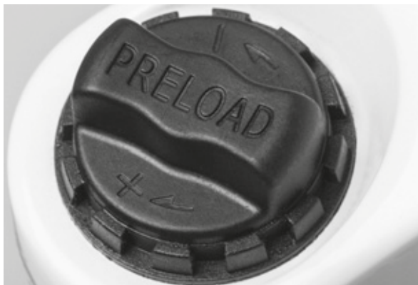
Figura 45: Manopola di regolazione dell'escursione negativa della sospensione sulla corona della forcella ammortizzata
