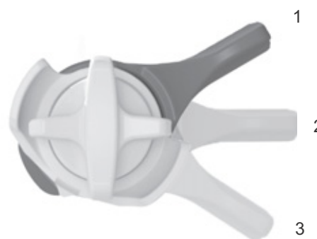
Figura 59: Regolatore dello stadio di pressione FOX sull'ammortizzatore del carro posteriore con le posizioni APERTO (1), MEDIO (2) e RIGIDO (3)
