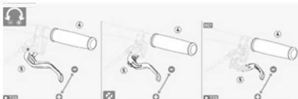
Figura 43: Regolazione dell'ampiezza di presa della leva del freno Magura con freno a disco
