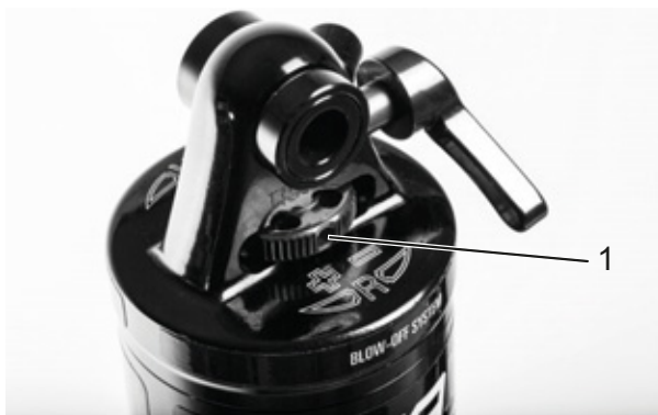
Figura 49: Regolatore del rebound Suntour (1) sull'ammortizzatore del carro posteriore
